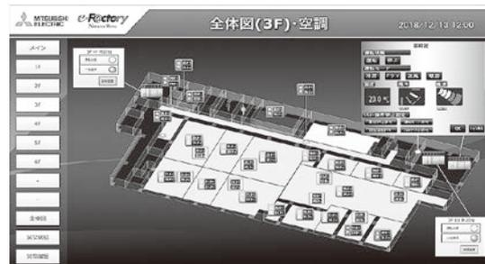
図4 MC Works64 空調制御画面
