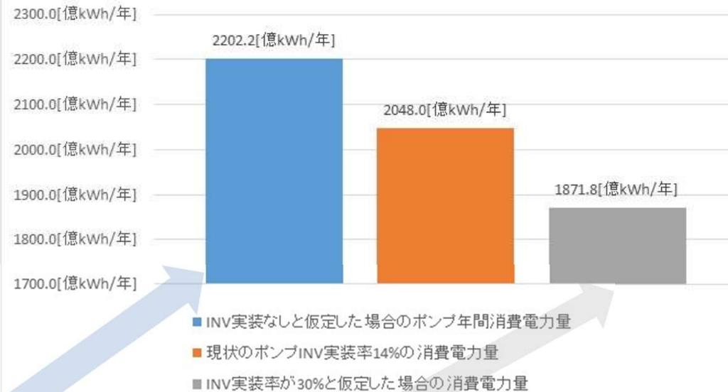
① 2202.2億kWhの86%のポンプが消費電力100%で運転し、14%がINV実装済みでモータ定格の50%消費電力で運転していると想定。
